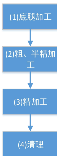
图 1.2 壳体加工生产流程图
