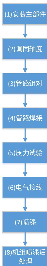
图 1.5 机组装配生产工艺流程图
